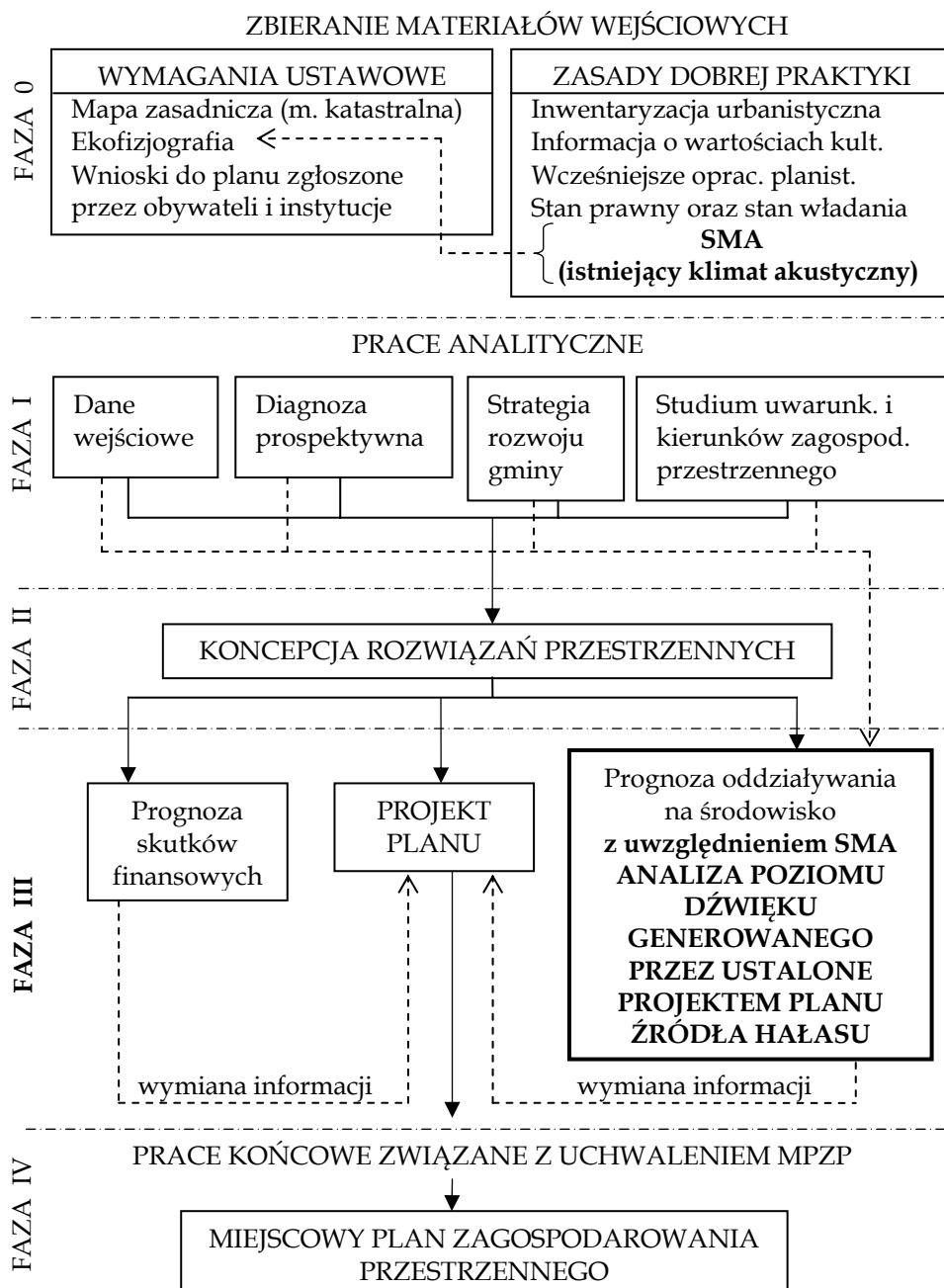
Rys. 2. Etapy opracowania miejscowego planu zagospodarowania przestrzennego z uwzględnieniem SMA. Źródło: opracowanie własne.
